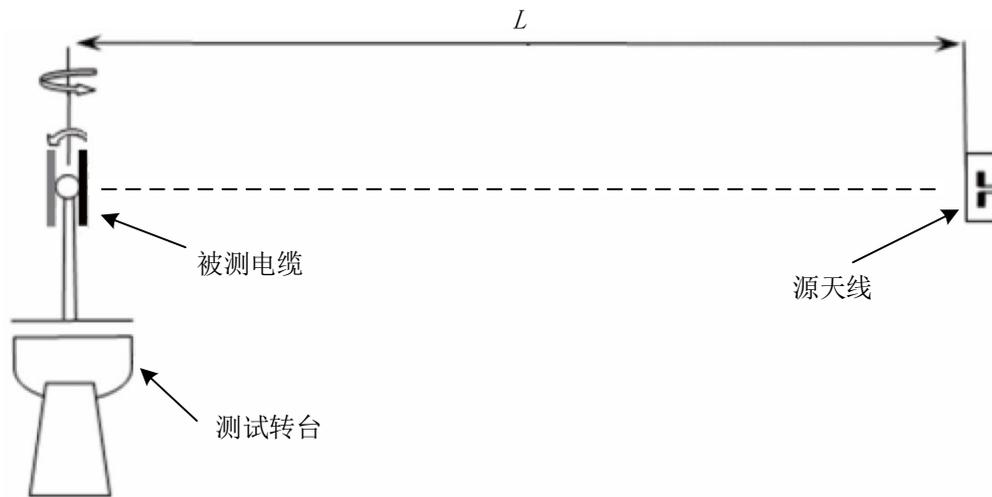
图E.1 圆周方向辐射场强测试装置
