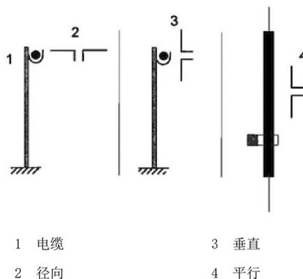
图B.2 架空敷设法中的天线方向
