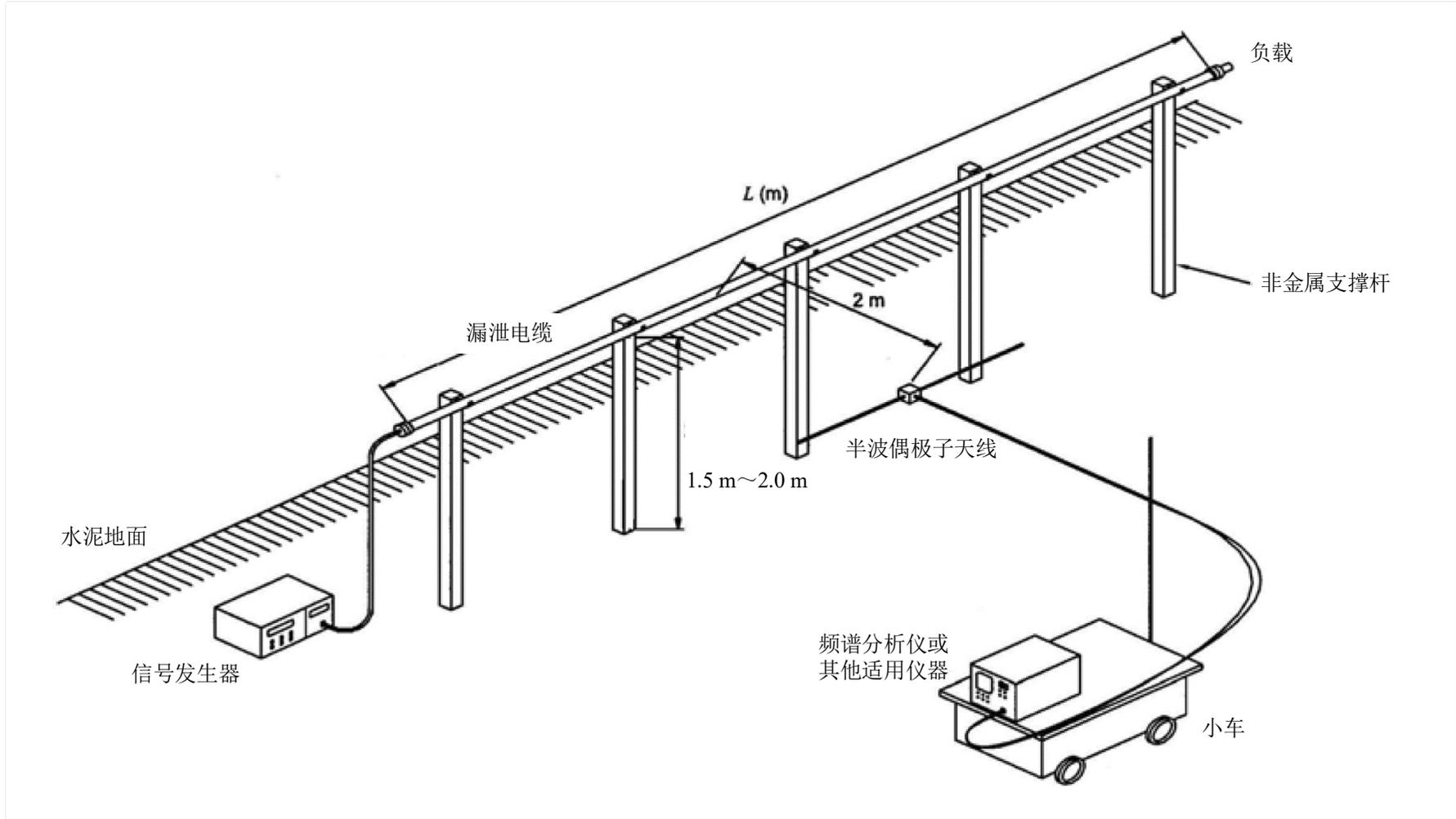
图B.4 架空敷设法测量耦合损耗
