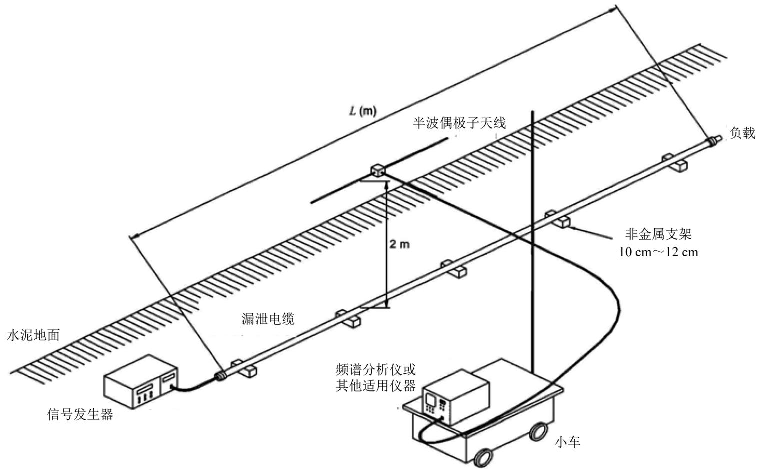
图B.3 地面敷设法测量耦合损耗
